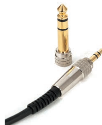
Kabel zakończony jest mini-jackiem (3,5 mm), ale w komplecie jest przejściówka na duży jack (6,3 mm), a wszystkie styki są pozłoczone.
