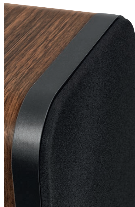
Maskownica 3050 bije rekordy „cienkości” – ma tylko 6 mm, a to korzystne dla ograniczenia odbić fal od jej ramek, które dodatkowo są wyprofilowane (od wewnątrz).
