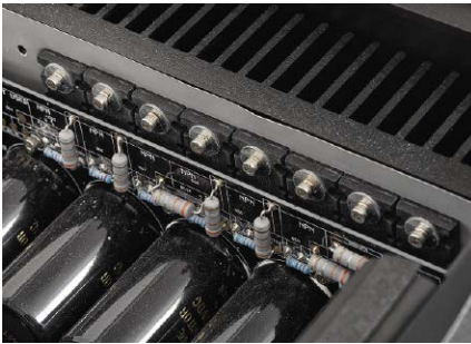
Na dużych płytkach przymocowanych do wielkich radiatorów umieszczono baterie 28 tranzystorów wyjściowych (oraz część sekcji zasilającej).
