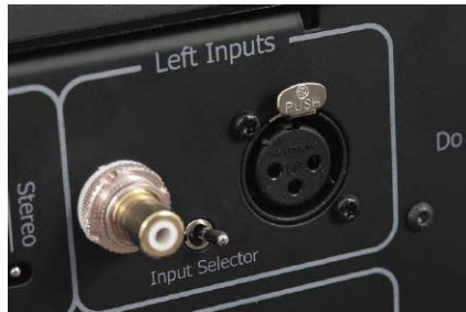
W każdym kanale są dwa niezależne wejścia, RCA oraz XLR, wyboru dokonujemy niewielkim przełącznikiem hebelkowym.
