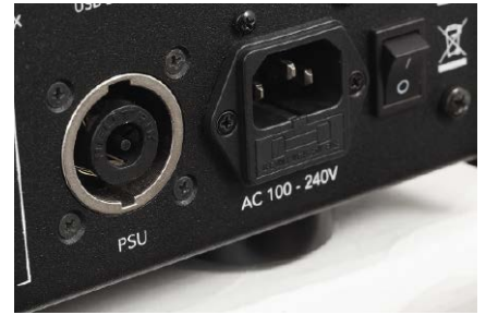
Dodatkowe oryginalne gniazdo jest przeznaczone dla zewnętrznego zasilacza PSU.
