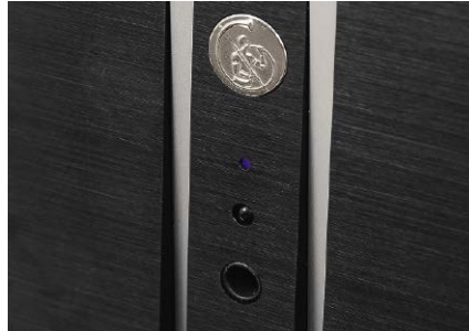
Pomiędzy dwoma przetłoczeniami, obok dyskretnych diod, znajduje się wyjście słuchawkowe (gniazdo 6,3-mm).
