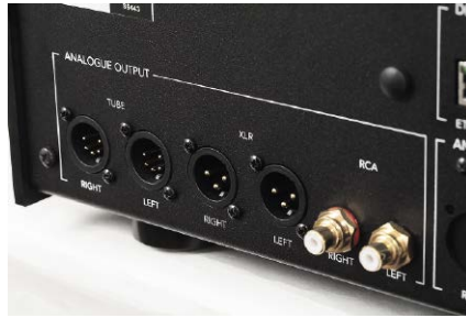
Dodatkowa para XLR-ów to wyprowadzenie sygnału dla opcjonalnego modułu lampowego.
