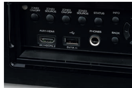
Wejście podręczne zapewni dzisiaj obsługę sygnałów 4K, jako że liczba źródeł w takiej specyfikacji szybko rośnie.
