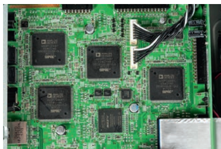
Wymagania w stosunku do procesorów audio nieustannie rosną, Denon zastosował aż cztery scalaki Analog Devices z gamy SHARC.
