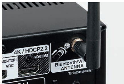
Denon stosuje dwie anteny dla systemów bezprzewodowych; moduł Wi-Fi pracuje w dwóch pasmach: 2,4 GHz oraz 5 GHz.
