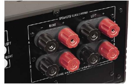
Terminale wyjściowe są podwójne, gniazda mają wprawdzie plastikowe nakrętki, ale porządne i wygodne.
