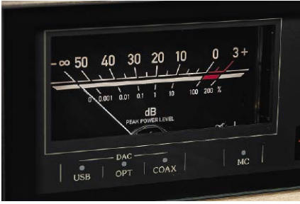
Wskaźniki wychyłowe poprawiono (względem E-370), rozszerzając skalę o 10 dB (w dół).
