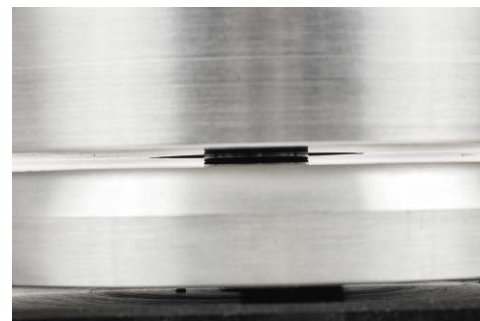
Tak ciężki talerz stanowiłby znaczne obciążenie dla łożyska, więc zastosowano wspomaganie poduszką magnetyczną.
