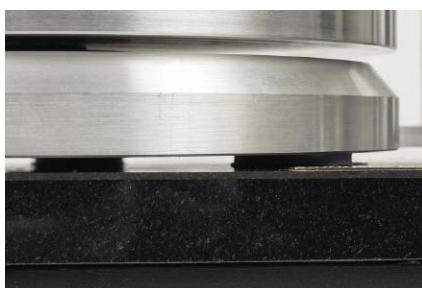
Okrągłą podstawę oddzielono od granitowej płytki absorberów.
