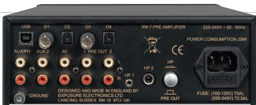
Exposure ma wszystkie wejścia i wyjścia, jakie charakteryzują nowoczesny i wszechstronny przedwzmacniacz. Są więc wejścia cyfrowe; wśród wejść analogowych – gramofonowe; jest też wyjście słuchawkowe.
