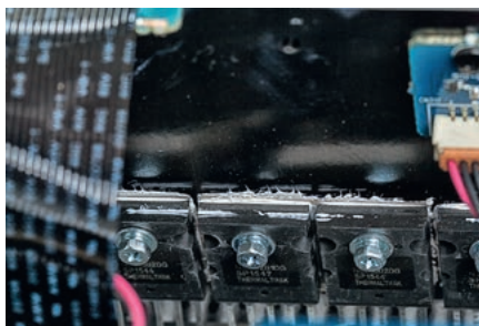
W każdym kanale pracują dwa elementy z rodziny ThermalTrak – Arcam wykorzystuje je od dawna.
