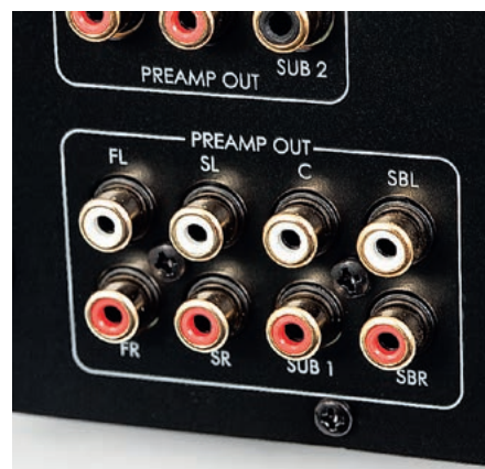
Wyjście na zewnętrzne końcówki mocy zostało podzielone na dwie sekcje, które w rezultacie składają się na komplet 11.2.
