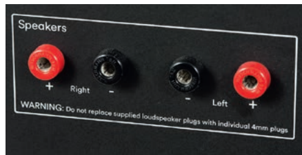
Skoro to Naim... szereg gniazd ma nietypową formę, pojedyncze terminale głośnikowe przyjmują wyłącznie końcówki banankowe.
