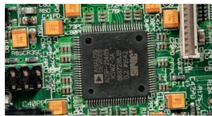
Sygnałami cyfrowymi ze wszystkich wejść zajmuje się procesor DSP z gamy Sharc – Analog Devices ADSP-21489.
