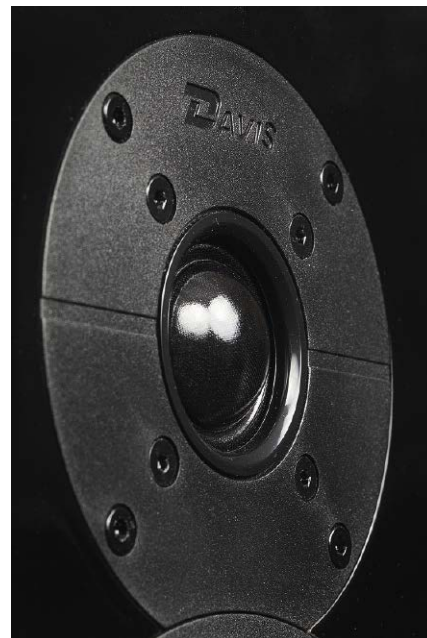
Jedwabna kopułka wysokotonowa ma średnicę 28 mm, mimo to jest filtrowana dość wysoko – wg producenta częstotliwość podziału wynosi 4 kHz.
