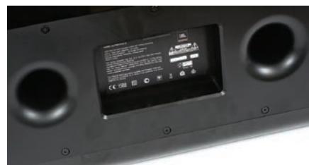
Na dolnej powierzchni znajdują się otwory bas-refleksów, jest też drugi panel przyłączeniowy z gniazdem sieciowym i cyfrowym wejściem optycznym.
