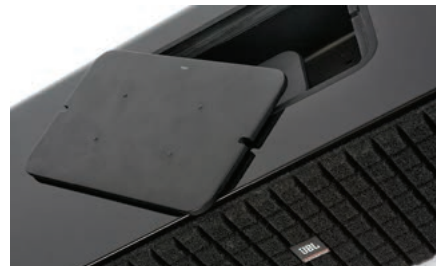
Górną pokrywę można odsłonić, uzyskując dostęp do gniazd i „grzybka” umożliwiającego zwinięcie i ukrycie przewodów.
