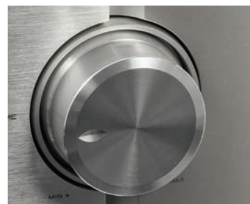
Klasyczny potencjometr służy tylko do odczytania położenia, nie jest jednak włączony w ścieżkę sygnału audio – to zadanie dla scalonego tłumika w sekcji przedwzmacniacza.
