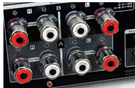
Zaciski głośnikowe oznaczone „A” są w modelach Marantza zazwyczaj umieszczane na dole, co może prowadzić do pomyłek.
