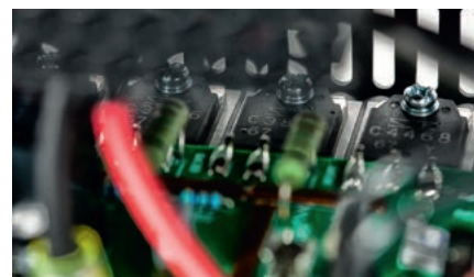
Pary bipolarnych tranzystorów firmy Sanken generują łącznie niemal pół kilowata mocy.
