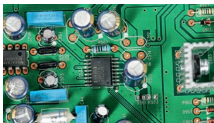
Nowoczesna regulacja głośności jest coraz częściej związana z układami scalonymi; seria PGA Burr Browna sprawdza się w takiej roli znakomicie.
