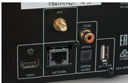
Arcam ma jedno wyjście HDMI, pojedyncze przyłącze USB oraz dwa wyjścia cyfrowe w popularnych formatach. Włączenie w sieć internetową wykonuje się standardowo, LAN-em lub bezprzewodowo; w drugim przypadku pomaga antenka, ale UP411 w niewielkiej odległości od routera działa i bez niej.
