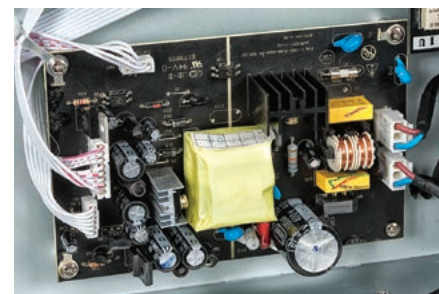
Zasilacz nie wygląda potężnie, ale poszczególne sekcje odtwarzacza są podłączone do odseparowanych obwodów.
