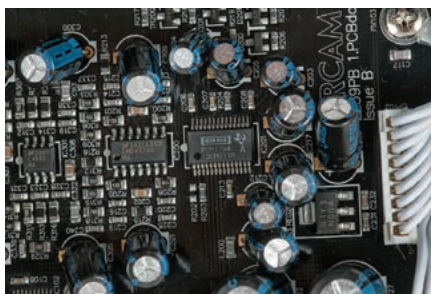
Głównym układem konwertującym sygnał z cyfrowego na analogowy jest Burr-Brown 1794.
