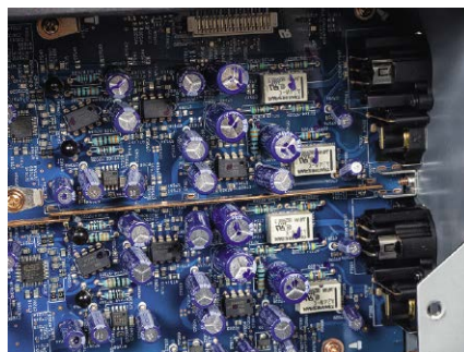
Sygnalami analogowymi zajmują się wzmacniacze operacyjne Burr-Brown.
