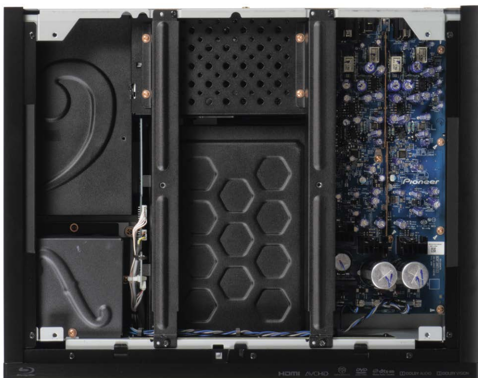
Sygnalami analogowymi zajmują się wzmacniacze operacyjne Burr-Brown.
