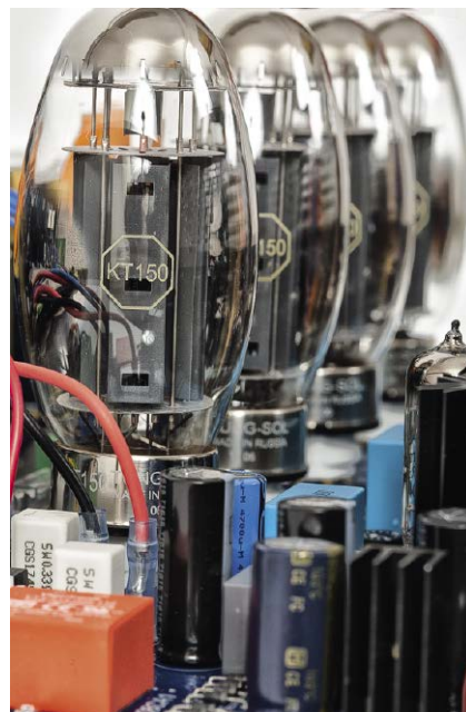
Lampy mocy przygotowała rosyjska firma Tung-Sol, elementy o oznaczeniach KT150 dostarczają tutaj ok. 100 W mocy wyjściowej.
