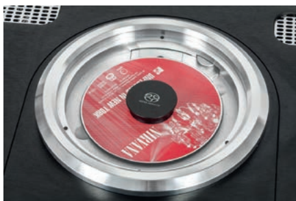
Płytę kładziemy w „miseczce” mechanizmu i dociskamy do talerzyka napędu krążkiem magnetycznym.
