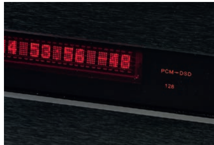
W wersji Signature dodano procesory, które przekładają sygnały PCM na DSD lub upsamplingują te ostatnie z płyty SACD lub zewnętrznych źródeł.
