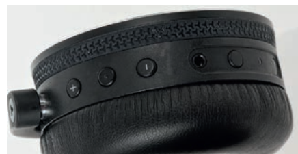
Wszystkie przyciski znajdują się na krawędzi muszli, jest tam również analogowe wejście audio oraz mikrofon do rozmów.
