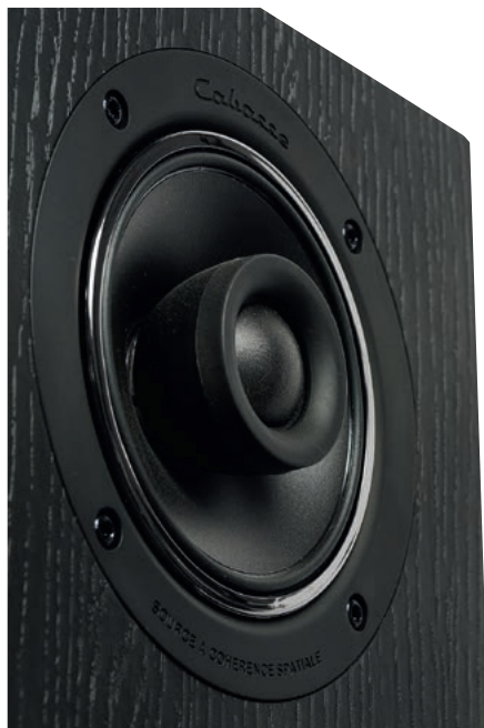
Membrana średniotonowa ma średnicę 85 mm, kopułka wysokotonowa – 25 mm. Nie jest to układ koncentryczny tak zaawansowany jak w droższych modelach Cabasse, ale spełnia najważniejsze założenia, zapewniając zgodność fazową w szerokim zakresie kątów.
